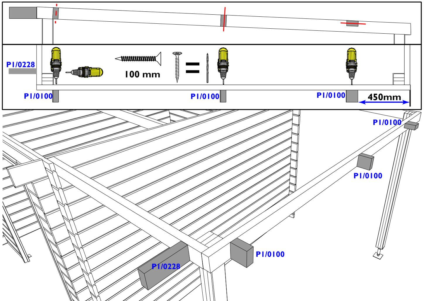
**DU:** Verteile extra (nach Modell) Hilfsbalken PI/0228 symmetrisch über die Länge des Anbau. Einige Modellen haben nur 2X PI/0100 an der Seite. Schauen Sie sich bitte genau die Teilleiste an.
