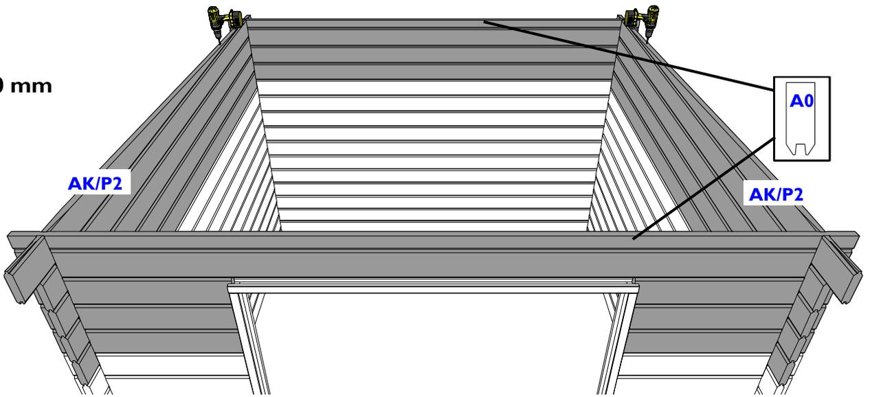
**DU:** Wenn es zu Unterschiedliche höhen kommt, Kontrolliert man zuerst ob jedes Bret gut anschließt. Um Unterschiedlichkeiten zu eliminieren (Detail A) sorgen Sie dafür das das oberste Bret auf gleiche Höhe kommt und schraube diese zusammen (Detail B). Jetzt sorgt man dafür durch jedes Brett eins nach dem andern ein bisschen hoch zuschieben den Spalt gleichmäßig über alle Bretter zu verteilen (Detail D).
